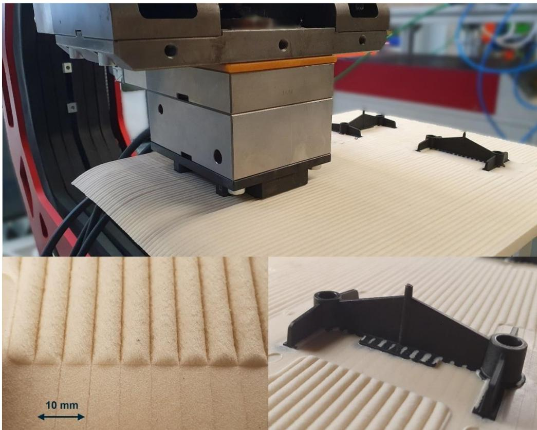
*Überspritzen der 3D gedruckten Strukturen (oben); Gegenüberstellung der 3D gedruckten und der kompaktierten Oberfläche (unten links); Aufgespritzte Rippenstruktur (unten rechts)*
