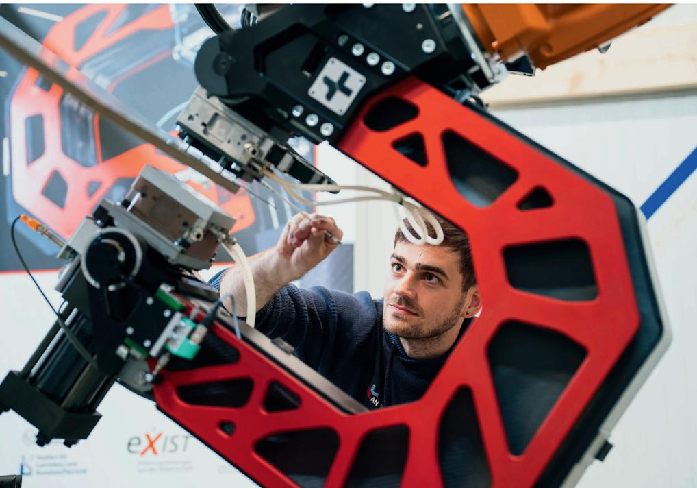
Der C-Bügel der mobilen Spritzgießeinheit von Anybrid ist an einem Sechssachsroboter montiert.
