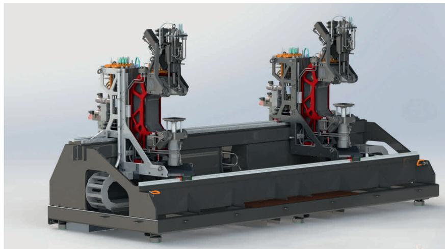
**Bild 2.** Das Innenleben von Ravin besteht aus einem oder mehreren C-Bügel-Leichtbaumodulen, die auf einer Linearachse angeordnet sind. © Anybrid
